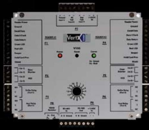
HIDVertX®製品は、アクセスコントロールソフトウェアホストシステムに対応する、本格的な機能を備えたハードウェア/ファームウェア・インフラストラクチャです。V100ドア/リーダー・インターフェイスは、ウィーガンドまたは Clock&Data インターフェイスを介して二台のアクセスコントロールカードリーダーに接続し、一つまたは二つのドアの制御を行います。V100はオンボードフラッシュメモリにより、プログラムアップデートをネットワークからダウンロードすることが可能です。V100は高速RS-485ネットワークによりV1000と接続できます。V1000は業界標準のTCP/IPプロトコルにより、10/100MbpsのEthernetまたはインターネットを介してシステムホストと通信を行います。このアーキテクチャは、わずか一つのTCP/IPアドレスでそれぞれ32のインターフェイスに対応し、低レベルのトランザクションをRC-485ネットワークで処理することにより企業LANへの影響を最小限に抑えます。
