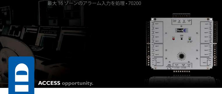
HID VertX製品は、本格的な機能を備えた、アクセスコントロールソフトウェアホストシステム用ハードウェア/ファームウェア・インフラストラクチャです。 V200入力モニタインタフェイスは 16 の監視対象入力回路と接続できます。各入力地点は、ノーマル、オフノーマル、タンパの状態を監視・報告します。 V200 はオンボードフラッシュメモリを搭載し、プログラムアップデートをネットワークからダウンロードすることが可能です。 V200 は高速 RS-485 ネットワークにより V1000 と接続できます。 V1000 は業界標準の TCP/IP プロトコルにより、 10/100Mbps の Ethernetまたはインターネットを介してシステムホストと通信を行います。 このアーキテクチャは、わずか一つのTCP/IPアドレスで各32のインタフェイスに対応し、低レベルのトランザクションを RS-485 ネットワークで処理することにより企業 LAN への影響を最小限に抑えます。
