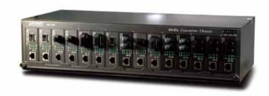
1台のシャーシにコンバータに多くの容量を提供し、PLANET MC-1500はまだメディア変換のメンテナンスを容易に光ファイバ配線のためのより多くのスペースを節約し、19"ラック15個のスロットを提供します。
