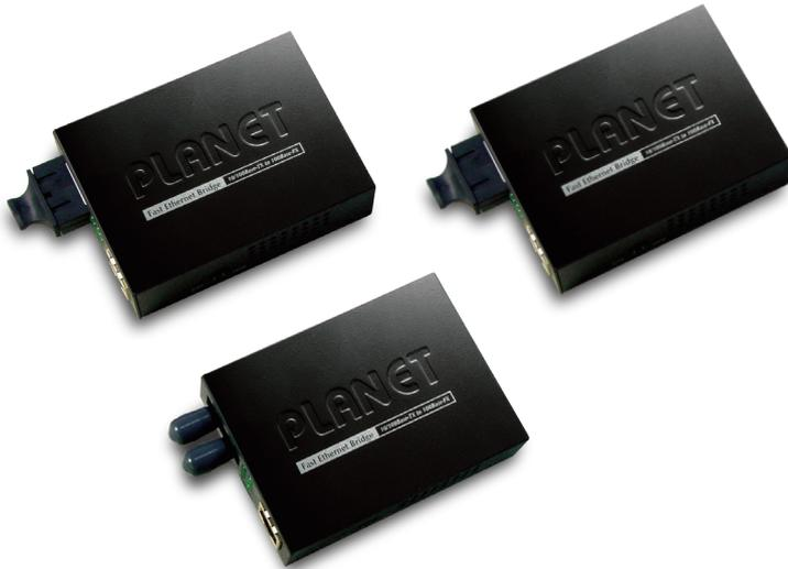
PLANET FT-80xは、ファストイーサネットブリッジ100BASE-FXファイバーから10 / 100BASE-TXシールド付きツイストペア ( STP ) コンバーターです。半二重と全二重の両方の操作と、さまざまなファイバーオプションをサポートします。コンバーターは、STPポートに接続されたデバイスがサポートする最高レベルのパフォーマンスに自動適応します。デバイスが全二重をサポートするスイッチまたはワークステーションである場合、コンバーターは全二重モードに適応し、有効な200Mbpsの帯域幅を提供します。接続されたデバイスが半二重のみをサポートするハブまたはワークステーションである場合、コンバーターは半二重モードに適応し、公称100Mbpsの帯域幅を提供します。オーバーライドスイッチは、光ファイバインターフェイスの半二重/全二重操作を完全に手動で制御します。コンバーターのファイバポートは1310nmで動作し、ST、SC、MTRJ、VF45、またはWDMコネクタを使用します。
