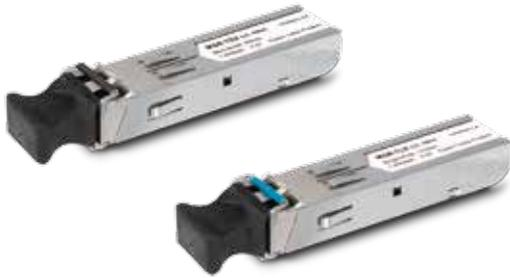
MGBファミリーは、具体的には、単一モード光ファイバ上の高性能集積二重データリンクのために設計されたスモールフォームファクタプラグブル (SFP) トランシーバモジュールから成ります。これらのトランシーバモジュールは、SFPマルチソースアグリーメント (MSA) およびホットプラグ可能に準拠しています。これらのモジュールは、ホスト機器の操作を中断することなくいつでも、SFP MSA 準拠のポートにインストールするための簡単な方法を提供します。
