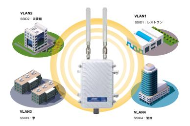
マルチSSIDの+のVLAN
