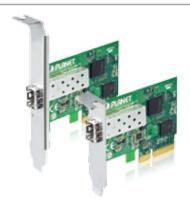
PCI Expressの回転にアップグレードされるENW-9801バージョン2 ENW-9801の新バージョン - 現在の高度に賞賛のバージョンから強化され、PLANETは、10GbpsのSFP + PCI Expressのサーバアダプタのブランドの新しいバージョンをリリースしました。2.0仕様X4インタフェースと他の高度な機能を次のように
