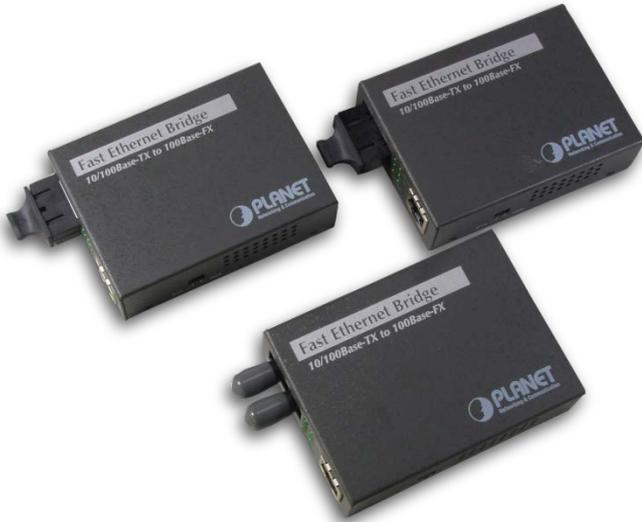
PLANET FT-80Xは10/100BASE-TXシールドドツイストペア(STP)ケーブルと100Base-FX光ファーストイーサネットを変換するメディアコンバーターです。全二重および半二重の対応ができ、接続先のデバイスのSTPポートにより、自動的に最高パフォーマンスに調整することが可能です。例えば、接続先はスイッチ、もしくは、全二重をサポートするワークステーションになっている場合、最大200Mbpsの帯域を提供します。接続先はハブ、もしくは、半二重をサポートするワークステーションになっている場合、自動的に半二重モードに切り替え、100Mbpsの帯域を提供します。また、ディップスイッチによる手動設定で全二重/半二重モードの切り替えもできます。コンバーターの光ポートは1310nmで動作し、ST、SC、MT-RJ、VF-45コネクタを使用しています。転送距離はマルチモードのモデルは最大2km、シングルモードのモデルは最大15/35/50kmになっています。
