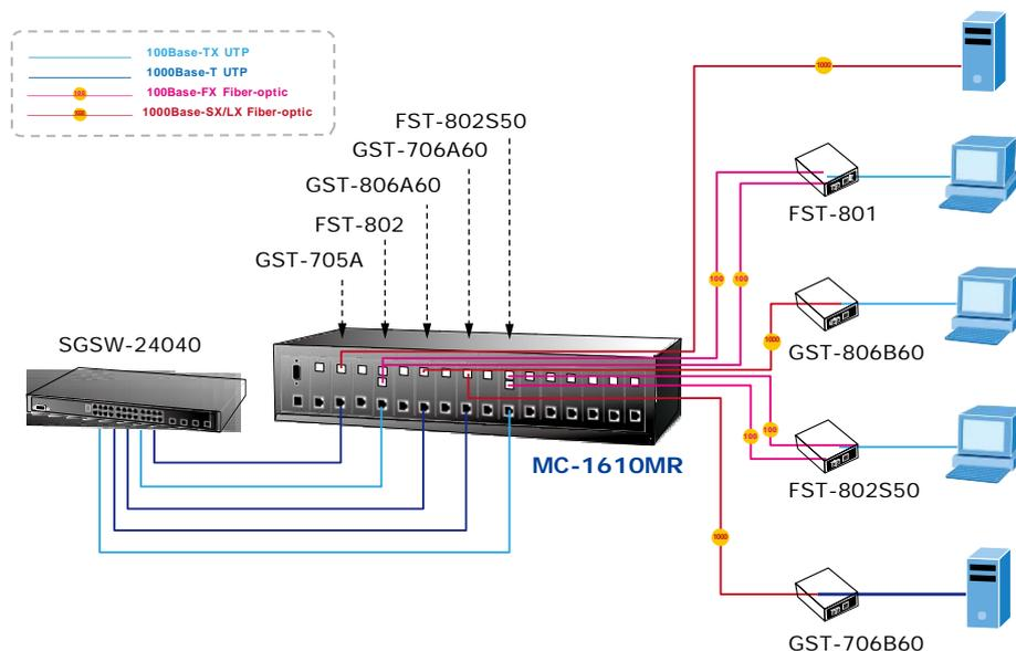
MC-1610MRシリーズは、ネットワークの連続稼働を確保するために、オプションのホットスワップ可能な冗長電源システム(RPS)をサポートしています。16スロットは柔軟的PLANETのファースト/ギガビットイーサネットスマートメディアコンバーター(FST-8 / GST-7 / GST-8シリーズ)を用いてFTTH (Fiber to the Home), FTTB (Fiber to the Building)の配置することができます。MC-1610MRシリーズは、転送距離長いや予算が厳しいネットワーク配置に信頼性持つ、かつ効率的なソリューションです。
