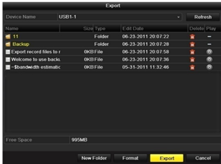
図 7.15 USB フラッシュドライブを使用したイベントによるエクスポート
